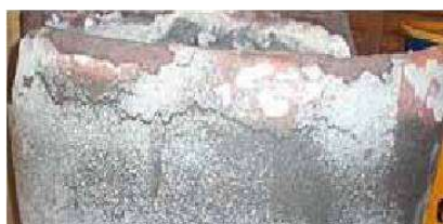
図5. セラミックブランケットが垂れ掛かっていたための低温酸化。
