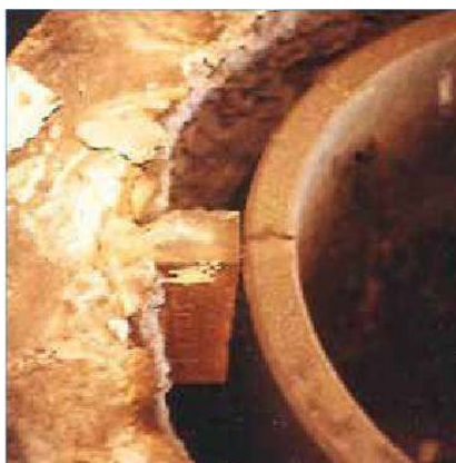
図3. 楔レンガとルツボにある程度隙間がないと縦割れすることがあります。
