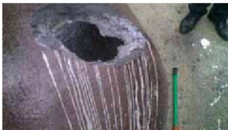
図 12.インゴット投入によるダメージ
