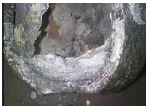
図 19 ルツボ底のドロス、不純物の蓄積
