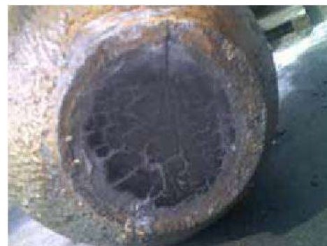
図 15.急加熱によるヒートショック
