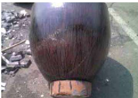
図 13.インゴットを水平にチャージしたことによるダメージ
